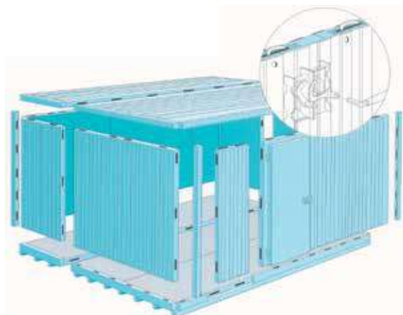
Assemblage des panneaux par crochets
