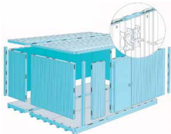
Assemblage des panneaux par crochets
